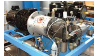
Estanqueidad sin mantenimiento de bomba de dosificación de polio e isocianato en máquinas de moldeado a alta presión
